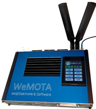
Das WeMOTA G2 der Firma Weiß Elektronik und Software GmbH ist ein Edge-Gateway für Fahrzeuge, die Entwicklern eine mächtige Edge-Logik zur Auswertung von Fahrzeugdaten im Feld bietet und benötigte Fahrzeug- und Umgebungsdaten auf den Punkt bringt. Entsprechend minimal sind die Datenübertragungsanforderungen in Richtung Cloud. Durch Over-the-Air Updates können jederzeit die zu ermittelnden Fahrzeug- und Umgebungsdaten neu parametrisiert werden.
