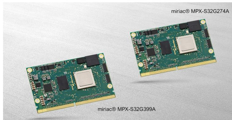
Das WeMOTA G2 basiert auf MicroSys miriac System-on-Modules mit NXP S32G Prozessoren, die durch nativen Support von CAN, FlexRay und LIN, sowie TSN-fähigem Ethernet und Ethernet T1 für den Einsatz in Fahrzeugen prädestiniert sind. MicroSys bietet sie derzeit in zwei Konfigurationen an mit entweder 4 Arm Cortex-A53 Prozessoren und 3 Arm Cortex-M7-Prozessoren oder mit 8 Arm Cortex-A53-Prozessoren und 4 als Dual-Lockstep-Paar geclusterten Arm Cortex-M7-Prozessoren.
