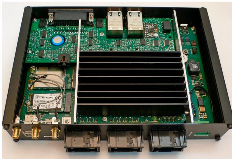
Weiß Elektronik und Software GmbH entwickelte eine eigene Mezzanekarte für Analogeingänge, TFT-Displaysupport, GPS, Beschleunigungs- und Gyrosensoren sowie Leistungsausgänge. Sie wird auf dem kundenspezifischen SBC montiert. Der Heatspreader des WeMOTA G2 koppelt direkt an das Gehäuse und ist in Richtung Modul passkonform ausgefräst.
