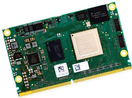
→ Das MicroSys miriac® MPX-S32G274A ist das weltweit erste System-on-Module, das den neuen NXP S32G2 Prozessor integriert, der speziell für Fahrzeugnetzwerke entwickelt wurde.
